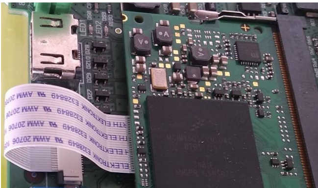
Figura 6- Conexão do cabo flat para utilização da interface HDMI
