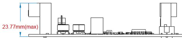
Figura 11 – Dimensões mecânicas Flexcard Energy (PR17033)
